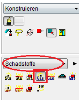
Abbildung 49: Werkzeugkiste links des Lageplan mit aufgeklappter Liste der Bibliotheken für die Prognoseart Gauß/TA Luft 1986
