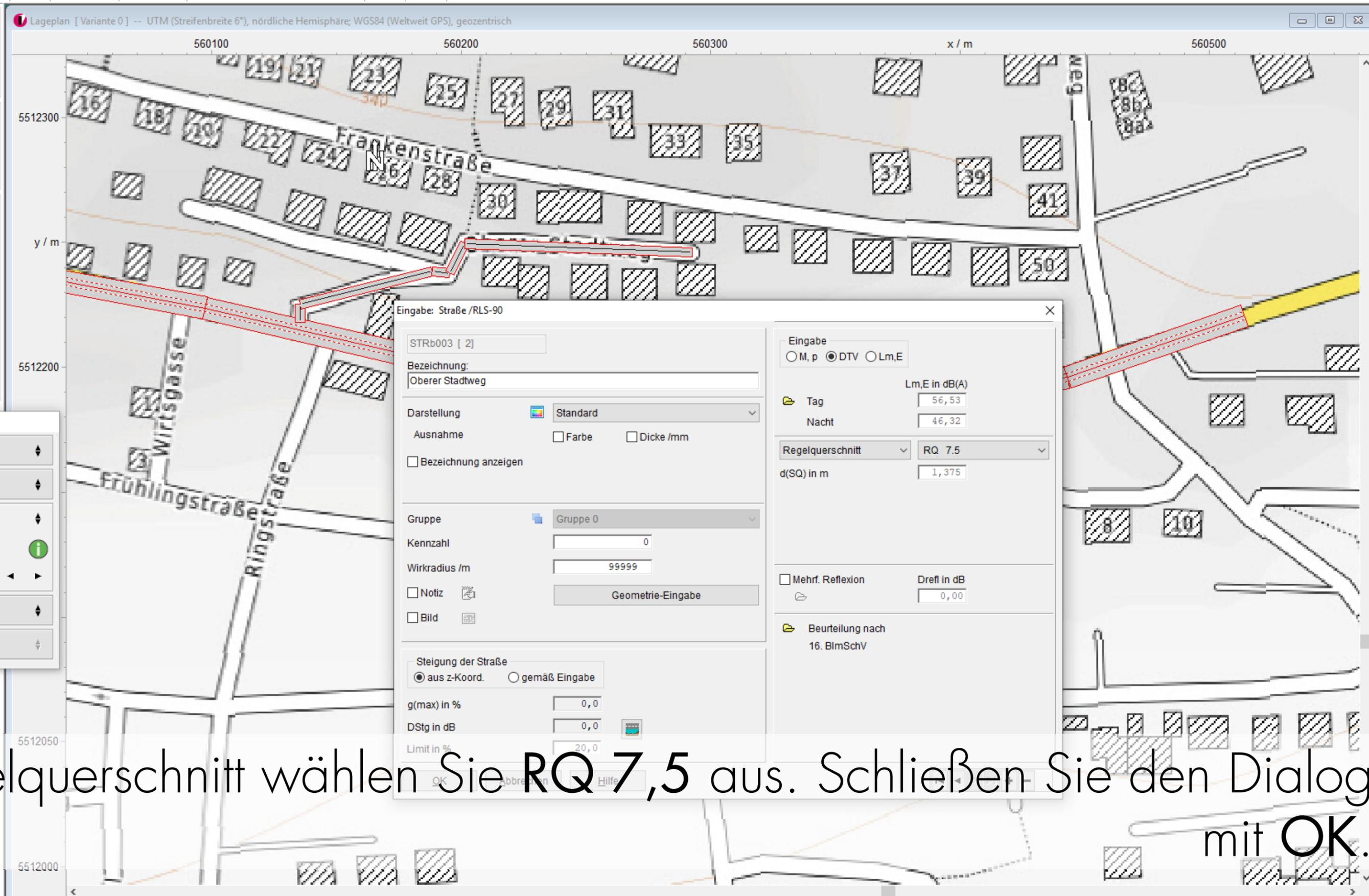
Als Regelquerschnitt wählen Sie **RQ 7,5** aus. Schließen Sie den Dialog mit **OK**.
